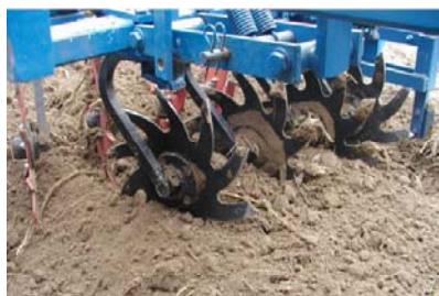
Disques étoiles d'un outil de travail du sol sur planches permanentes en maraîchage (« MTCS » du GRAB).
